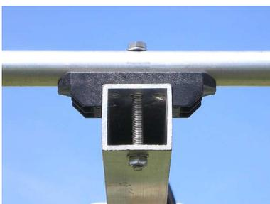
Die Parasitärelemente werden direkt mit einer M5 x 55 mm Schraube und einem Elementhalter auf den Boom geschraubt. Dafür erhalten sowohl das 16mm Rohr als auch der Boom in der Mitte je ein 5,5mm Loch. Beim Verschrauben wird auf jeder Seite der Schraube eine Unterlegscheibe eingefügt.
