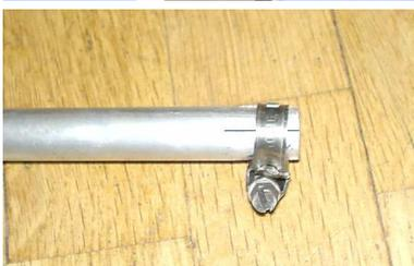
Achtung: Die angegebenen Längen der einzelnen Rohre müssen unbedingt eingehalten werden, denn das Tapering ist in der Antennen-Simulation berücksichtigt. Wird das Tapering verändert, muss die Antenne komplett neu berechnet werden!
