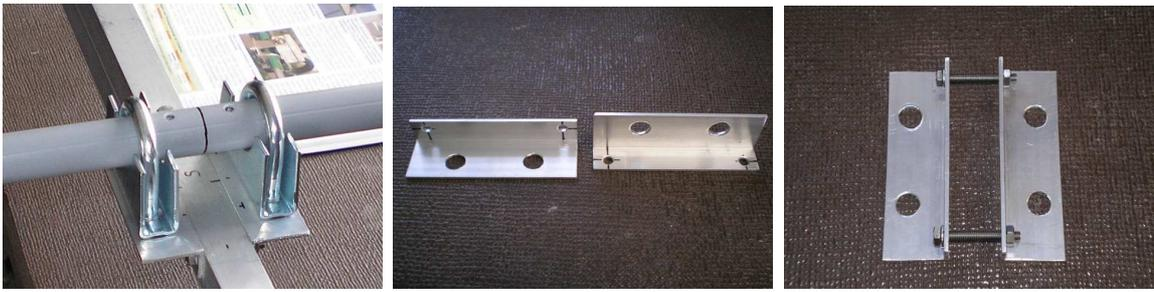
**Die Dipolhalterung:** Der Strahler muss vom Boom isoliert befestigt werden. Die Dipolhälften werden mit einem Isolierrohr vom Rest der Antenne isoliert und über zwei Rohrschellen und zwei Alu-Winkel am Boom befestigt. Oben links sehen Sie eine kleine Vorschau, wie es aussehen soll. Im Bild zu sehen sind unten die Dipolbefestigungbacken, die Rohrschellen und das Isolierstück, welches die Strahlerhälften vom Rest der Antennen isoliert.
