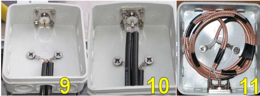
**Bild 9:** An das eine Ende werden die 4mm Kabelschuhe gelötet und mit den 3,9 x 16 mm Blechschrauben direkt an den Strahlerrohren befestigt. Bei Verwendung von RG59 wird das Kabel erst über ein Loch nach außen geführt, dort aufgerollt, und dann
