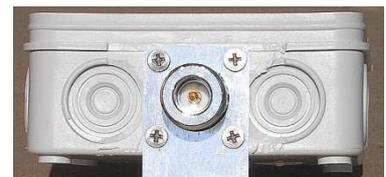
die Flanschbuchse hinein, und verwenden Sie die Flanschbuchse als Bohrschablone für die vier Befestigungslöcher (3mm). Montieren Sie das beiliegende Erdungsblech mit der Flanschbuche an der Dose (4x Schrauben M3x12mm). Anschließend knicken Sie das Erdungsblech rechtwinklig unterhalb der Dose ab und bohren an dessen Ende mittig ein Loch hinein, welches dann zur Befestigung der Dose am Boom dient.
