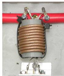
Bei 432 MHz Antennen kann das Kabel ebenfalls in der Dose untergebracht werden, bei der Verwendung von RG59 ist jedoch die genaue Position des Strahlers in der Dose vorher durch Probieren zu ermitteln, da RG59 relativ steif ist und sich nicht so bequem verlegen lässt wie RG179.
