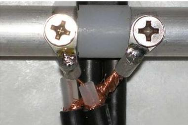
Auf der Strahlerseite wird nun die Anpassleitung mit den 4mm Kabelschuhen (oder Lötösen) sowie den Blechschrauben am Dipolrohr befestigt. Achten Sie dabei unbedingt auf möglichst kurze Anschlussdrähte, da diese den Strahler mechanisch verlängern.
