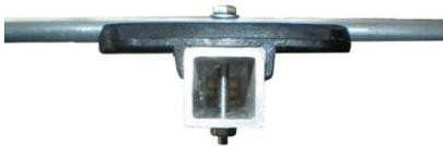
An den Markierungen für die Bohrlöcher (nur Reflektor und Direktoren) bohren Sie 3,5mm oder 4,5mm Locher, je nach Schraubendurchmesser, mittig in den Boom. Das Element wird dann wie abgebildet auf dem Boom montiert.
