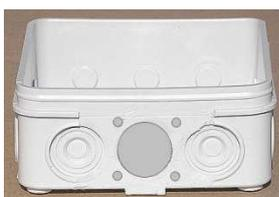
Entfernen Sie **nur auf einer Seite** der Dose die Befestigungslasche und schneiden Sie dort das mittlere Loch aus. Entfernen sie die überstehenden Ränder vom mittleren Loch und jeweils etwa die Hälfte von den linken und rechten Durchführungen, damit das Erdungsblech gut aufliegen kann. Legen Sie
