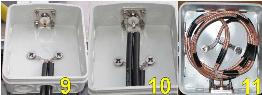
**Bild 9:** An das eine Ende werden die 4mm Kabelschuhe gelötet und mit den 3,9 x 16 mm Blechschrauben direkt an den Strahlerrohren befestigt. Bei Verwendung von RG59 oder RG58 wird das Kabel erst über ein Loch nach außen geführt, dort
