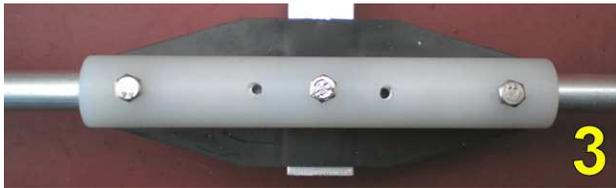
**Bild 3:** Als Erstes wird der Strahler gebaut. Es wird ähnlich wie bei den Parasitärelementen ein großer Elementhalter auf dem Boom befestigt. Ein spezieller Dipolverbinder dient gleichzeitig als isolierendes Zwischenstück für die Strahlerhälften und zusammen mit dem Elementhalter als Haltevorrichtung.
