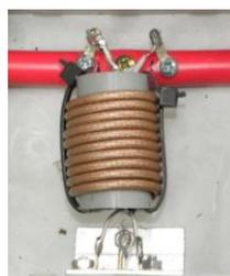
Bei 432 MHz Antennen kann das Kabel ebenfalls in der Dose untergebracht werden, bei der Verwendung von RG59 ist jedoch die genaue Position des Strahlers in der Dose vorher durch Probieren zu ermitteln, da RG59 relativ steif ist und sich nicht so bequem verlegen lässt wie RG179.
