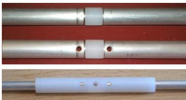
Nachdem die **Dipolrohre innen entgratet** wurden, werden die Strahlerhälften bis zum Anschlag auf das Dipolverbindungsstück geschoben. Bei Antennen mit 6 oder 8mm Strahlern werden die Rohre **IN** den Verbinder bis zum Anschlag geschoben (unteres Bild). **Bitte prüfen Sie vorher ob das Strahlerrohr auch in den Verbinder hineinpasst.**
