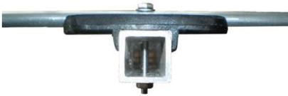
An den Markierungen für die Bohrlöcher bohren Sie 3,5mm bzw. 4,5mm Locher, je nach Schraubendurchmesser, mittig in den Boom. Das Element wird dann wie abgebildet auf dem Boom montiert.
