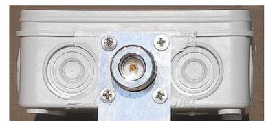
(4x Schrauben M3x12mm). Anschließend knicken Sie das Erdungsblech rechtwinklig unterhalb der Dose ab und bohren an dessen Ende mittig ein Loch hinein, welches dann zur Befestigung der Dose am Boom dient.
