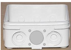
Entfernen Sie **nur auf einer Seite** der Dose die Befestigungslasche und schneiden Sie dort das mittlere Loch aus. Entfernen sie die überstehenden Ränder vom mittleren Loch und jeweils etwa die Hälfte von den linken und rechten Durchführungen, damit das Erdungsblech gut aufliegen kann. Legen Sie die Flanschbuchse hinein, und verwenden Sie die Flanschbuchse als Bohrschablone für die vier Befestigungslöcher (3mm). Montieren Sie das beiliegende Erdungsblech mit der Flanschbuche an der Dose
