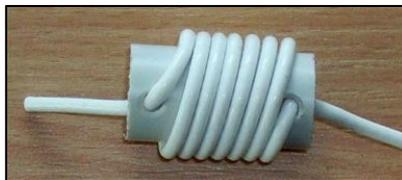
Da Antennen im 50 Ohm Design keine spezielle Anpassung benötigen, bedarf es nur einer kleinen Kabeldrossel zur Unterdrückung von Mantelwellen. Die Kabeldrossel ist ein auf PVC Rohr gewickeltes 50 Ohm Koaxialkabel (bei uns RG188) dessen Enden auf der einen
