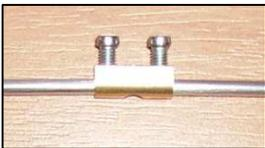
Da der Reflektor bei 144 MHz Yagis in der Regel länger als 1m ist (Stablänge) verlängern Sie diesen mit der beigefügten Lüsterklemme (ohne Kunststoffmantel) und einem passend zurechtgeschnittenem Reststück von den anderen Elementen.
