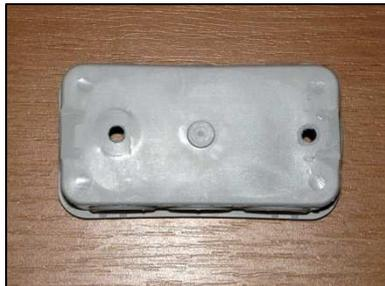
Schneiden Sie beide Befestigungslaschen ab. Schneiden Sie auf der einen kurzen Seite ein Loch zur Befestigung der Koaxanschlußbuchse in die Membran (16mm bei UHF und N Buchsen, 10mm bei BNC Buchsen). Für die Montage auf dem Boom werden durch den Dosenboden zwei Löcher benötigt. Eines direkt beim Dipol auf der Gegenüberliegenden Seite
