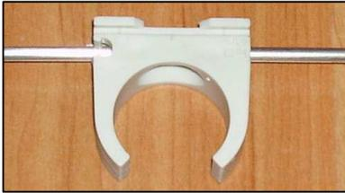
Für die Parasitärelemente werden Aluminiumstäbe mit 3,2mm Durchmesser mitgeliefert (bei einigen Antennen ausnahmsweise auch 4,0mm). Die Elemente werden mit Klemmschellen an den PVC Rohren befestigt. Kürzen Sie die Aluminiumstäbe auf die geforderte Länge gemäß der Tabelle mit den Abmessungen.
