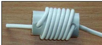
Da Antennen im 50 Ohm Design keine spezielle Anpassung benötigen, bedarf es nur einer kleinen Kabeldrossel zur Unterdrückung von Mantelwellen. Die Kabeldrossel ist ein auf 16mm PVC Rohr gewickeltes 50 Ohm Koaxialkabel (bei uns RG188) dessen Enden
