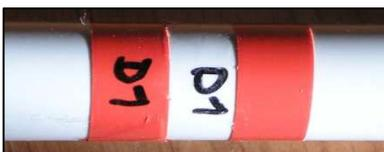
Markieren sie nun die Stellen, an denen die Antennenelemente gesetzt werden müssen. Wir empfehlen vor und hinter der Stelle Isolierband als Markierung anzubringen und in der Mitte Platz für genau eine Klemmschelle frei zu lassen.
