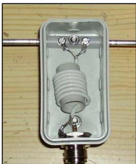
An die zwei Lötösen löten Sie nun Seele und Abschirmung des Koaxkabels vom anderen Ende der Kabeldrossel an, achten Sie aber dabei unbedingt auf möglichst kurze Lötanschlüsse. Welche von beiden auf welche Seite gehört, spielt keine Rolle. Nur beim Stocken von identischen Antennen müssen jeweils Innenleiter und Abschirmung auf der jeweils gleichen Seite sein.
