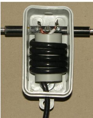
**Achtung:** Das Bild zeigt eine kleine Anschlussdose wie sie bei Leichtbauyagis verwendet werden. Für die stabile Aluminiumversion ist eine größere 85 x 85mm Anschlussdose vorgesehen. Die mitgelieferte kleine Dose wird für die Zusammenschaltung verwendet!
